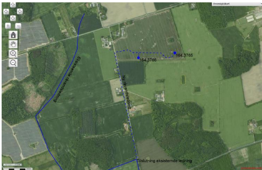
Figur 3. Forventede placering af råvandsledninger, adgangsveje og tilslutningspunkt til den eksisterende råvandsledning. Kilde: NIRAS.
