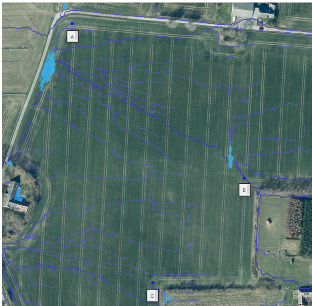
Figur 3. Kort fra Scalgo live der viser områderne, hvor der kan opstå oversvømmelse og strømningsvejende i overfladen ved skybrud og tøbrud. Det skal sikres, at borerne placeres eller etableres, så der ikke strømmer vand ind til dem.
