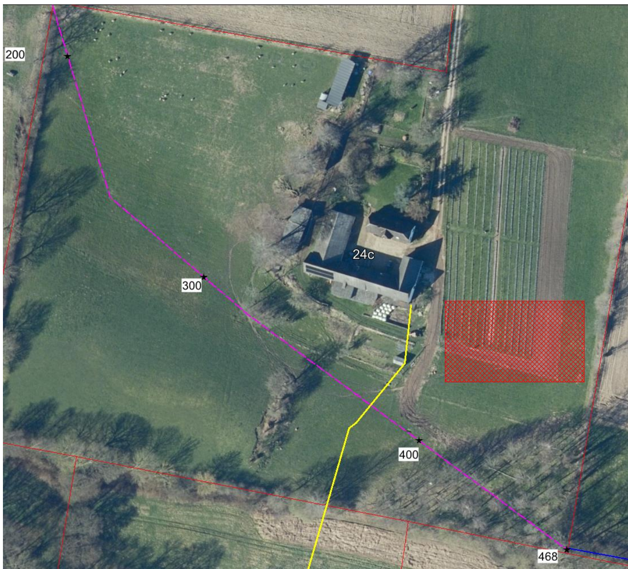
Figur 4: Ledningsoplysninger inden for projektområdet. Elkabel (gul streg), jordvarmeanlæg (rød skravering), Vrangbækkens nuværende forløb (pink streg), matrikelgrænser (rød streg).
